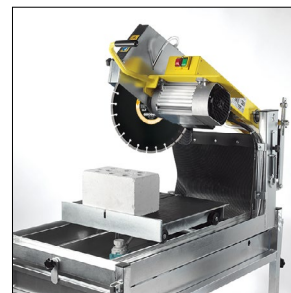
Schneiden von 15-er Modulsteinen (25 x 19 x 14,5). Hohe Beweglichkeit des Wippkopfes ermöglicht eine höhere Schnitttiefe im Umdrehschnitt.
