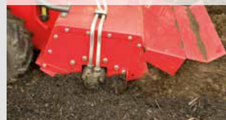
Leicht zugänglicher Ölmotor am Fräskasten
